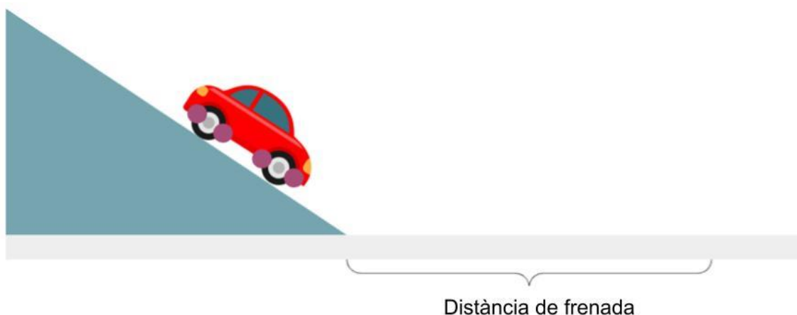
Figura 1: Representació esquemàtica del muntatge experimental per mesurar la distància de frenada. Es pot observar que les rodes del cotxe de joguina s'han frenat amb plastilina, per tal de simular una frenada a la carretera.
