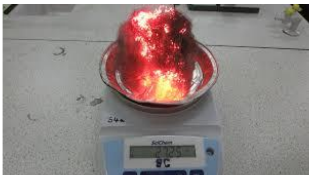
Figura 1: La llana de ferro sobre bàscula, la massa de la qual augmenta a temps real a mesura que la llana de ferro s'oxida.
